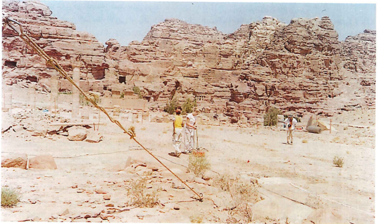
استخدام الرادار النافذ (GPR) لطبقات الأرض لإجراء المسح الشامل والتنقيب الأثري
